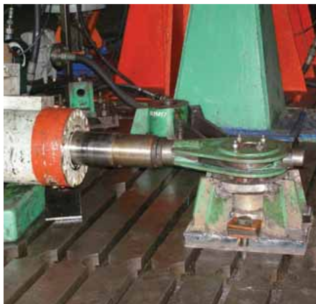
Стендовые испытания шкворня.
