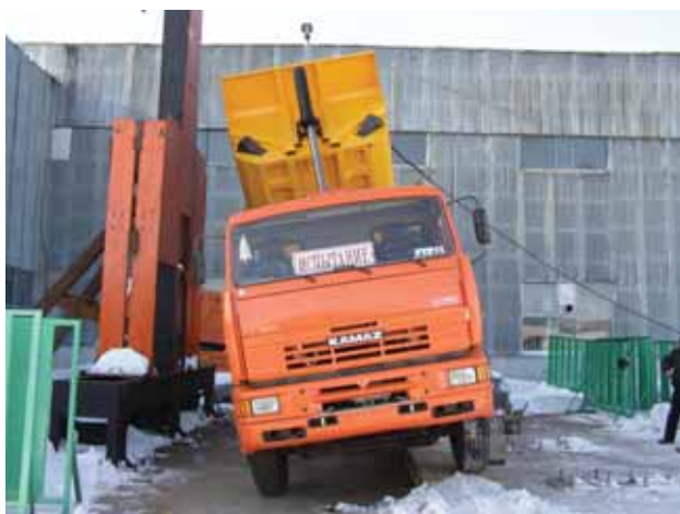
Определение критического угла при разгрузке автосамосвала КАМАЗ-6520 с платформой овального сечения с «зависшим» грузом.
