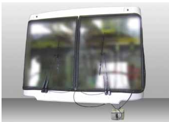
Испытание по определению работоспособности стеклоочистителя
